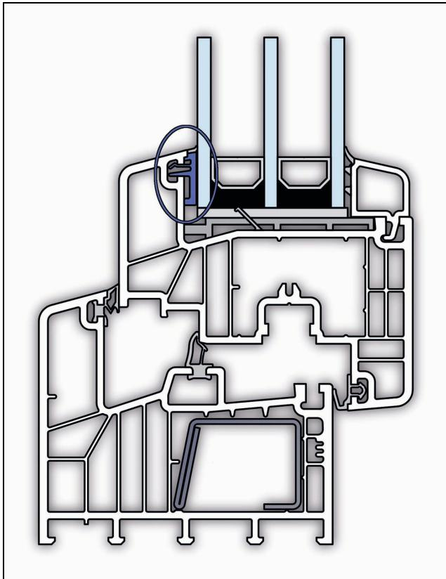
Die innovative Klebeadapter-Technologie von profine ermöglicht dem Verarbeiter eine rationelle und wirtschaftliche Trockenverklebung.
